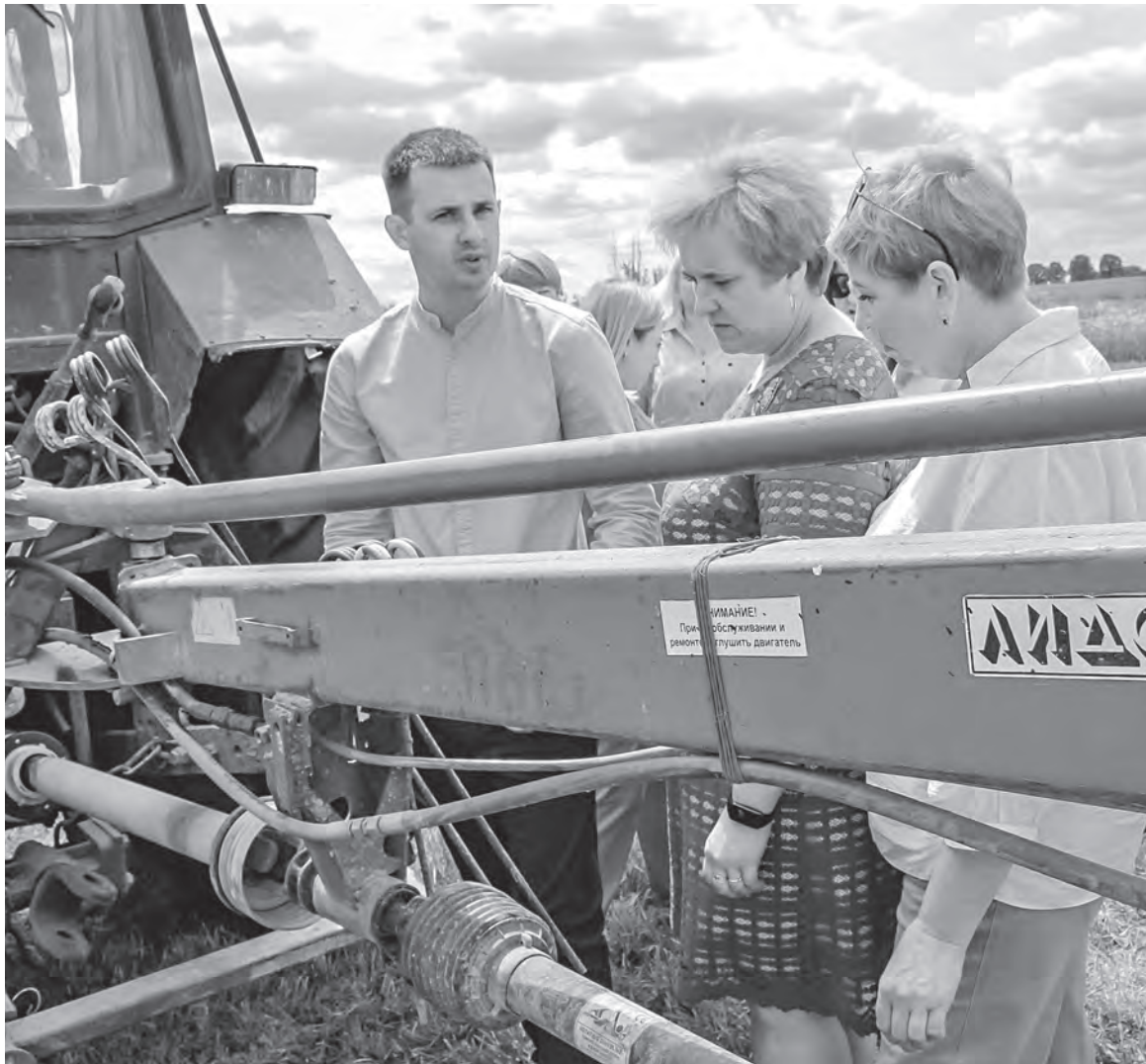
Главный технический инспектор труда областной организации Белорусского профсоюза работников АПК Евгений Зуй показывает, как должна выглядеть защита карданного вала механизма.
